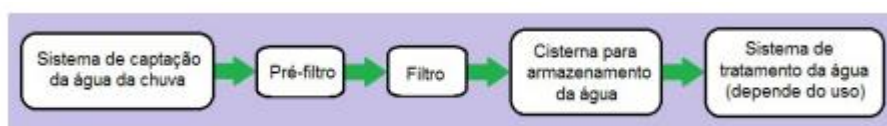
Figura 4. Componentes do sistema de filtração da água da chuva para dessedentação animal
